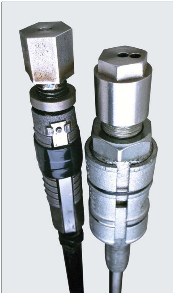
Una vista de cerca de las cabezas de referencia para los extensómetros de tubo EX1 y EX2 (derecha).
