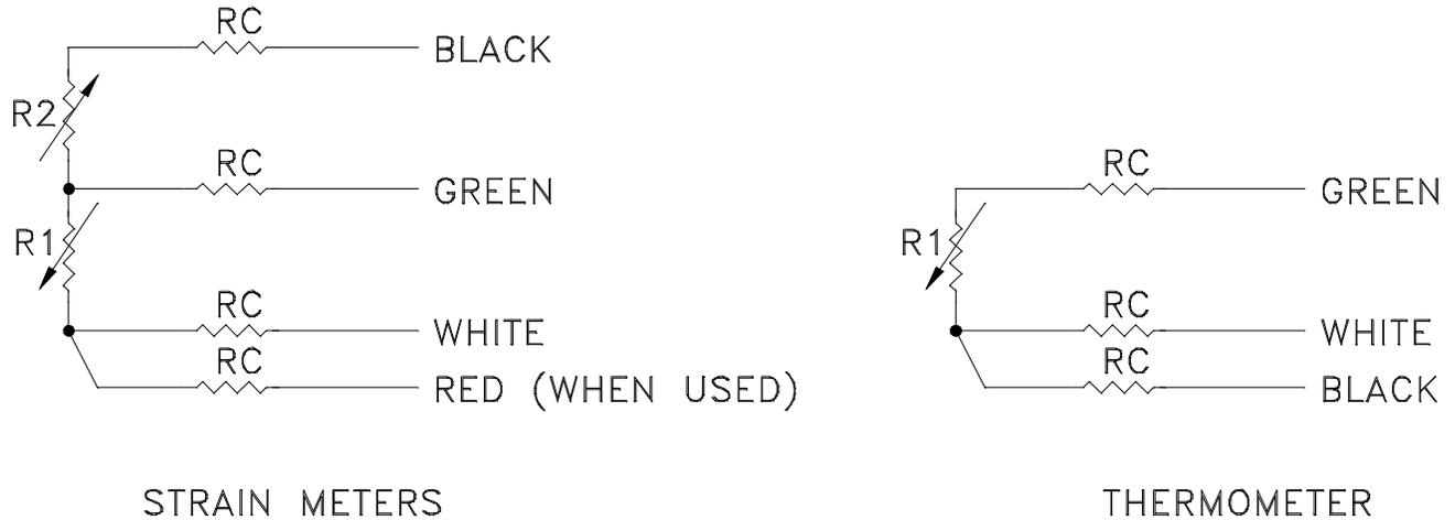
*Fig. 2, Carlson Meter Electrical Diagram*
